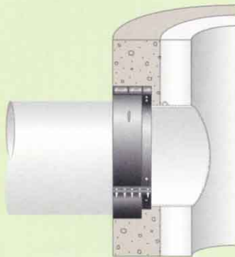
巻立てコンクリート施工
